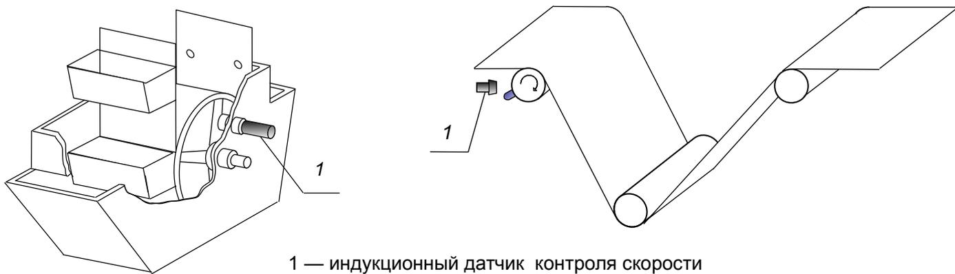
Рисунок 15 — Установка бесконтактного индукционного выключателя
